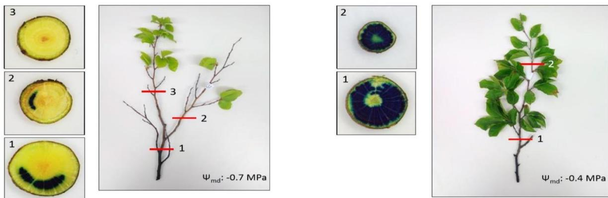
Abbildung 1 Linke Abbildung: Geschädigte Leitbahnen im Zweig / Rechte Abbildung: Nicht beschädigte Leitbahnen im Zweig – Versuch mit eingestelltem Zweig in eingefärbtem Wasser
